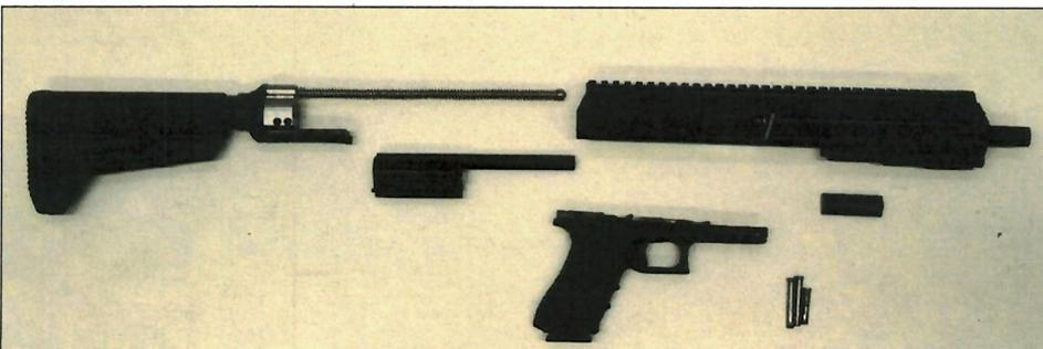
Abbildung 3: Wechselsystem Norlite „USK-G“, montiert auf Griffstück „Glock 17 Gen. 4“, zerlegt in die jeweiligen Hauptgruppen
